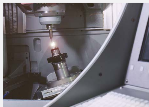
Vollautomatisches Fräsen von komplexen Elektroden
