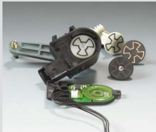
Induktive Sensoren mit heißgeprägter Leiterbahn
