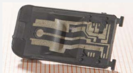
Leiterbahnen, gefertigt mit Laserdirektstrukturierung (LDS)
