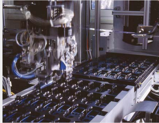
Trays transportieren die Formteile zur Montage
